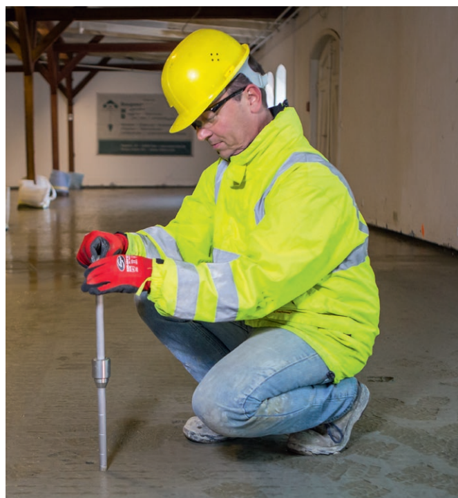
Пенетрометр HUMM надежно определяет оптимальное время начала затирки бетона
